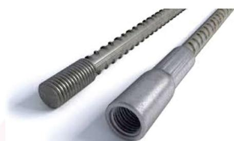
Dizajn kaplera omogućava povezivanje armature gde karakteristike ostaju iste kao kod neprekinute armature, i prenos opterećenja se vrši preko nje, a ne preko betona, kao kod preklapanja.
